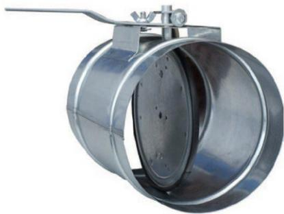
**Дроссель-клапан** (или дросселирующая заслонка) — это устройство, позволяющее регулировать просвет в данной точке воздуховода с целью изменения производительности. Он устанавливается в разрыв канала и регулирует поток газо-воздушной смеси путем изменения угла поворота заслонки (лопатки).
