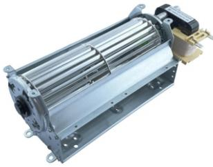
**Тангенциальные вентиляторы** - Вентиляторы, у которых отношение ширины корпуса к диаметру больше, чем 1 к 3. Корпус несколько схож с обычными центробежными вентиляторами, но воздуховод расположен не в торце, а по всей длине боковой стороны. Движение воздуха происходит перпендикулярно оси вращения. Широко применяются в системах кондиционирования, различных вентиляционных системах, тепловых завесах, при вентиляции и охлаждении требуемых объектов, в том числе микросхем и даже ДВС.
