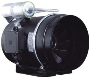
**Взрывозащищенные вентиляторы** - Такие устройства используются для перемещения взрывоопасной среды и хоть являются не отдельным типом вентилятора, а лишь его модификацией, заслуживают особого внимания. Простыми словами, это вентилятор, защищенный от искрообразования и нагрева до опасных температур. Обязательным условием является взрывозащищенный двигатель. Важным параметром при подборе считается соотношение уровня взрывоопасности рабочей среды и взрывозащищенности оборудования.
