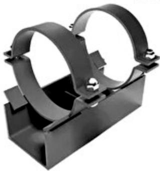
**Скользящая опора** - является изделием, используемым при монтаже трубопровода надземной прокладки. Поддерживают трубопровод, но не препятствуют его смещениям при температурных изменениях. Скользящие опоры должны воспринимать вертикальные нагрузки от массы нагруженного трубопровода. Обеспечивают возможность теплового перемещения трубопровода в направлении его оси и в поперечном направлении.
