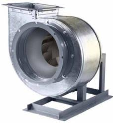
**Вентиляторы дымоудаления** - Несмотря на схожее название, используются совершенно для других целей. Их назначение – удаление дыма из помещения в случае пожара. Довольно серьезный агрегат, требующий обязательной сертификации, в ходе которой тестируется его способность в течение 1 часа выдерживать температуру не менее 600°С.
