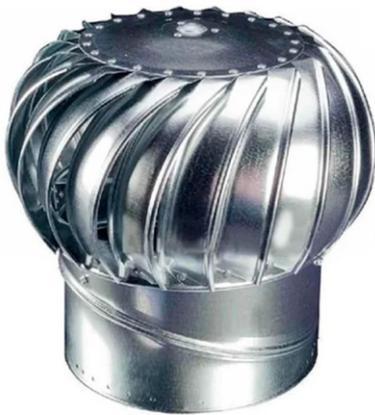
**Турбодефлектор** - вращающееся вентиляционное устройство предназначено для улучшения работы естественной вытяжной вентиляции. За счет вращения лопастей внутри турбодефлектора создается область разреженного воздуха, удаление отработанного воздуха из помещения происходит за счет разницы давления.
